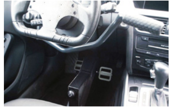
De aandrijving van de FitCar; Trappers, verkleind stuur en een handbediend rempedaal
